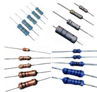
شکل (۵): انواع مقاومتها، یک نوع مقاومت کربنی و نحوه خواندن مقدار آن
