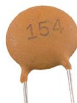
شکل (۷): خازن سرامیکی از نوع عدسی
