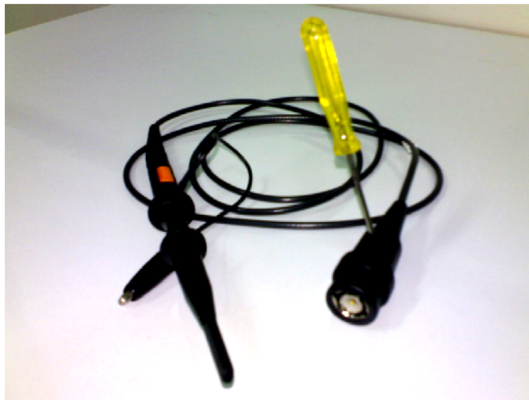
شکل (۱-۹): نحوه تنظیم خازن تریمر پروب
